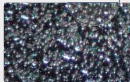
Powiększona powłoka fosforanów cynku złożona z kryształów różnej wielkości
